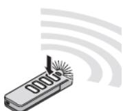
**In cazul în care usa este echipată cu sistem de acționare de la distanță din telecomanda, comenziile de deschidere – stop – inchidere se fac din butonul/butoanele active ale telecomenții, în secvență
